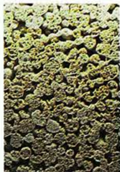
Glas-Poren mit isolierender Luft
